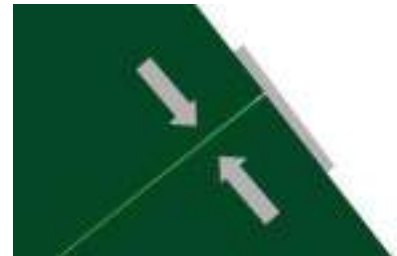
Incollaggio dei lembi del manto
